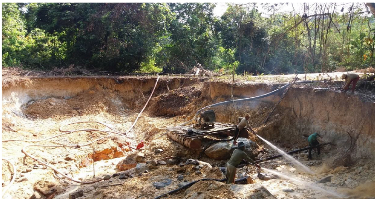
Figura 3 - Lavra por desmonte hidráulico
