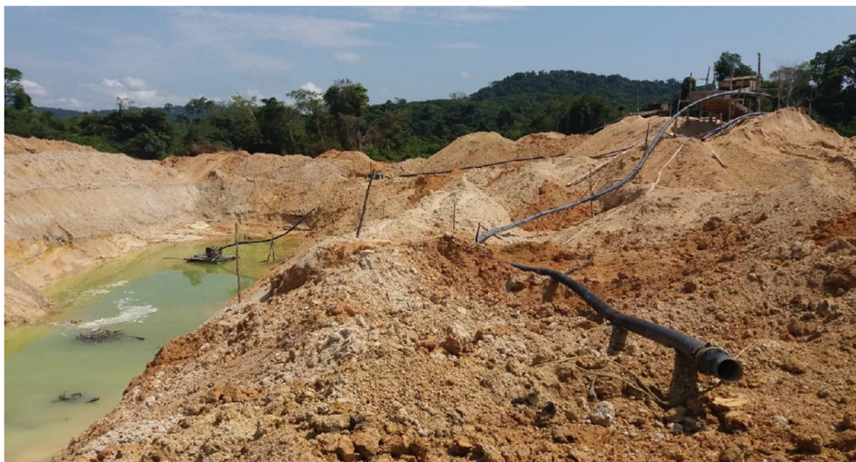
Figura 4 - Transporte de material em polpa por dragagem e sucção
